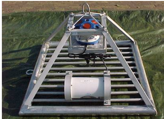
Figuur 3 ADCP geplaatst in meetframe
